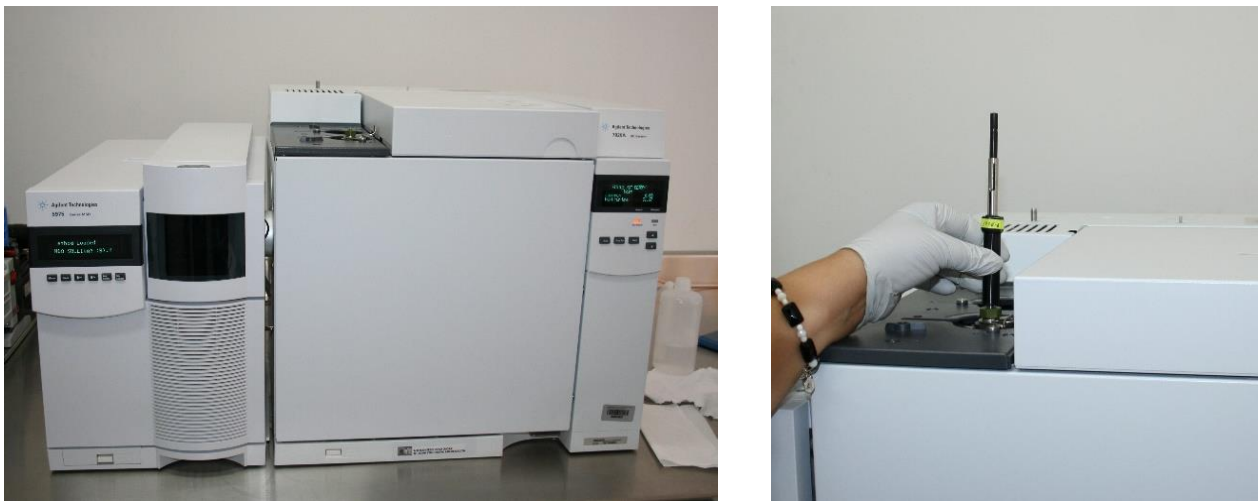
Figura 4. Cromatógrafo de gases acoplado a masas para la determinación de volátiles asociados a guayabas y adultos de picudo de la guayaba y detalle de la inyección de la microfibras de extracción.
