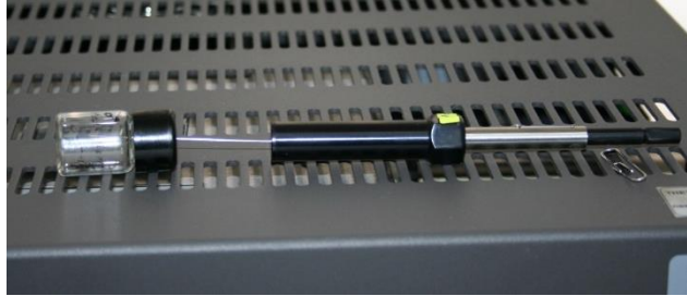
Figura 3. Sistema de detección de volátiles mediante la microextracción en fase solida (MEFS).
