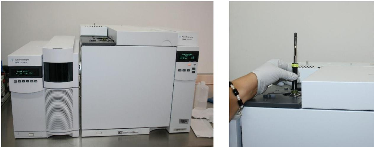
**Figura 4.** Cromatógrafo de gases acoplado a masas para la determinación de volátiles asociados a guayabas y adultos de picudo de la guayaba y detalle de la inyección de la microfibras de extracción.
