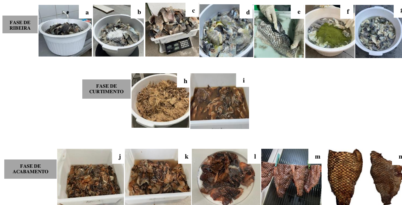
Figura 3. Processo sustentável de curtimento de pele de tilápia do Nilo ( Oreochromis niloticus ): Fase de ribeira – (a) lavagem; (b) remolho; (c) pesagem; (d) caldeio; (e) descarte; (f) purga; e, (g) desengraxe. Fase de curtimento – (h) piquele; (i) curtimento das peles. Fase de Acabamento: (j) neutralização; (k) recurtimento; (l) engraxe; (m) secagem; (n) couro. Fonte: os autores.
