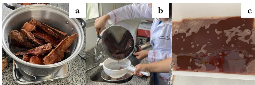
Figura 1. Procedimento de extração de taninos de cascas de Schinus terebinthifolius (aroeira): (a) aquecimento das cascas; (b) coagem da solução de aroeira; (c) extrato final de aroeira. Fonte: os autores.
