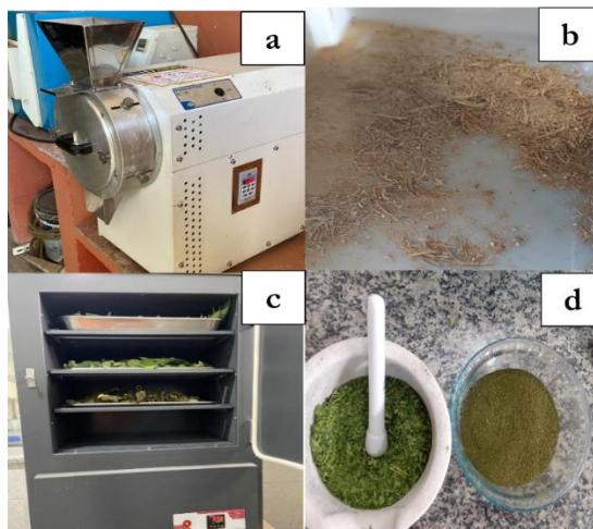
Figura 2. Processamento de pericarpo de babaçu ( Attalea speciosa ) e folha de mamoeiro ( Carica papaya ) para curtimento de pele de tilápia do Nilo ( Oreochromis niloticus ): (a) moinho de facas; (b) pericarpo de babaçu triturado; (c) estufa de circulação forçada com bandejas contendo folhas de mamoeiro; (d) pó de folhas de mamoeiro em almofariz, após passar por trituração manual e peneiramento. Fonte: os autores.
