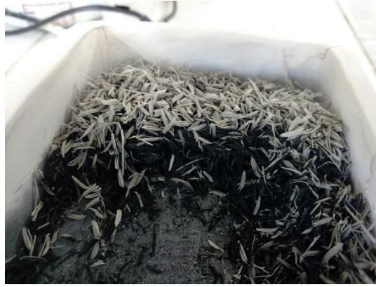
Figura 5. Cinza de casca de arroz PEL718020, produzida com ciclo isotérmico de 700°C por 180 minutos em forno mufla, evidenciando uma frente de combustão mais intensa na camada superior. Fonte: Autores, 2020.
