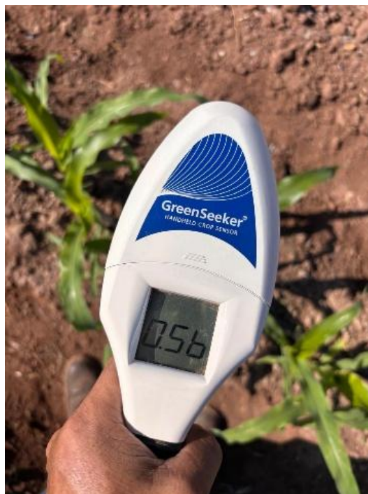
Figura 16. Medición del NDVI en el maíz usando dispositivo portátil Green Seecker.
