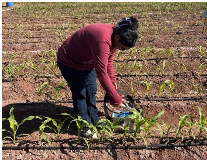
Figura 17. Medición del intercambio gaseoso utilizando un sistema portátil de fotosíntesis (PP-System).
