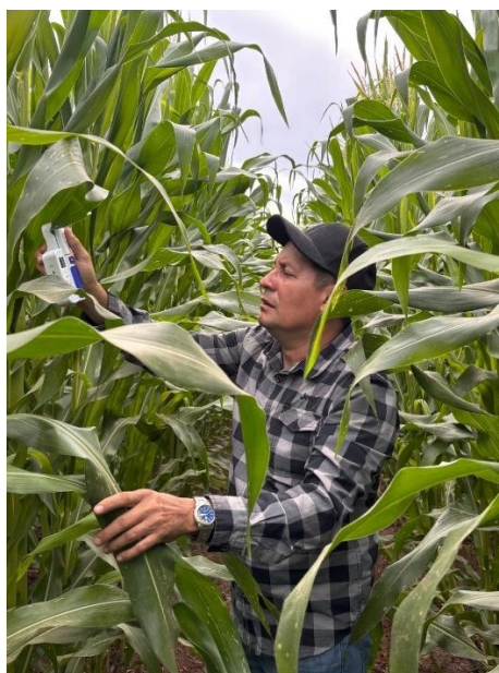
Figura 15. Medición de la clorofila en el maíz usando dispositivo portátil SPAD.
