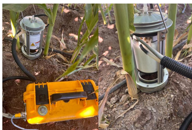
Figura 18. Medición del intercambio gaseoso del suelo utilizando la cámara de respiración de suelo.
