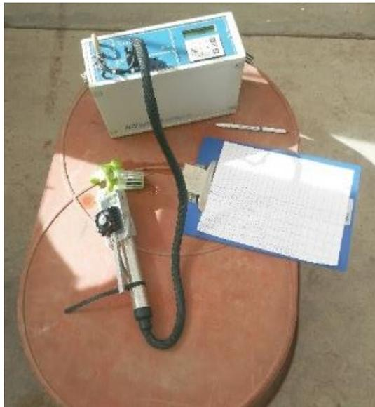
**Figura 6.** Multiparámetro de la marca “PP SYSTEMS” con plántula de lechuga en la cámara de medición para determinar fotosíntesis, transpiración y conductancia estomática.
