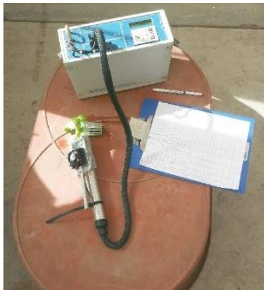
Figura 6. Multiparámetro de la marca “PP SYSTEMS” con plântula de lechuga en la cámara de medición para determinar fotosíntesis, transpiración y conductancia estomática.
