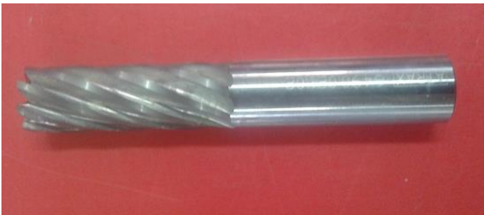
Figura 4. Fresa de vástago de pequeño diámetro. Fuente: Y. J. Rodriguez Silva.
