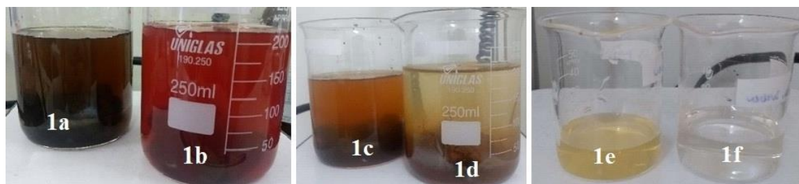
Figura 3. Remoção da coloração da solução do corante vermelho ponceau 4R com o Processo Foto-Fenton ( \text{Fe}/\text{H}_2\text{O}_2/\text{UV} ): (1a) 0 min; (1b) 30 min; (1c) 90 min (1d) 120 min; (1e) 180 min (1f) 210 min. Fonte: os autores.
