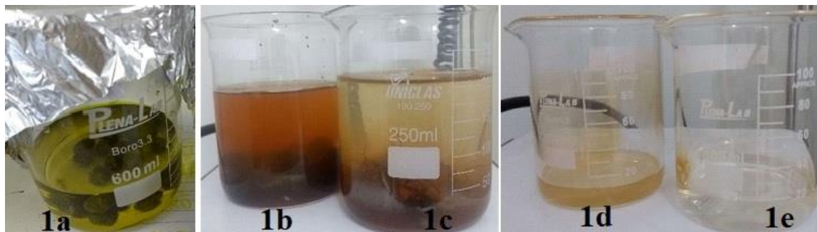
Figura 2. Remoção da coloração da solução do corante amarelo tartrazina com o Processo Foto-Fenton ( \text{Fe}/\text{H}_2\text{O}_2/\text{UV} ): (1a) 0 min; (1b) 60 min; (1c) 120 min; (1d) 180 min; (1e) 210 min. Fonte: os autores.
