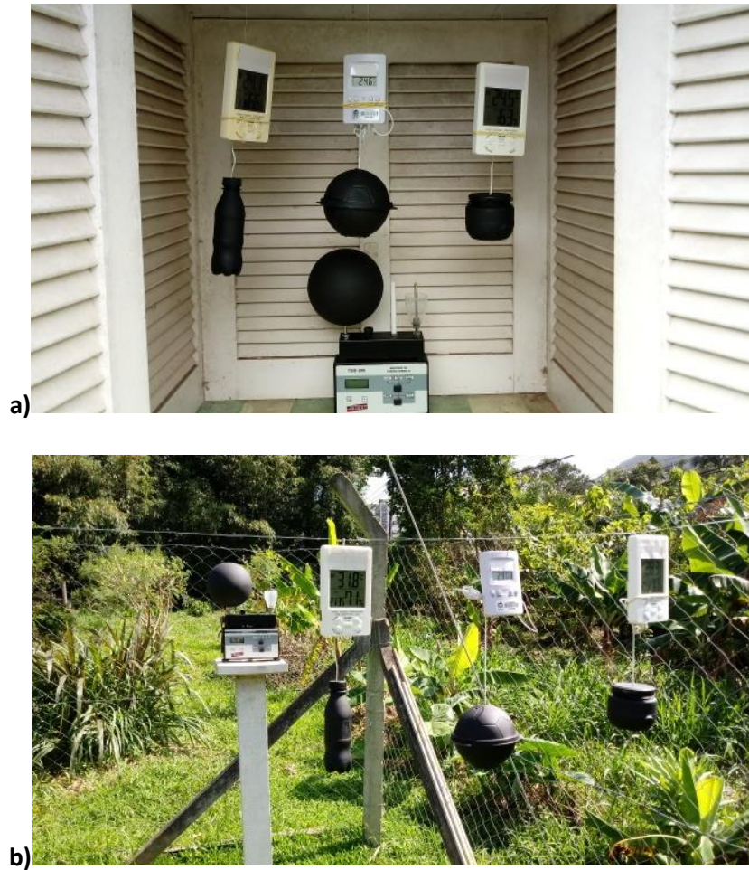
Figura 2. Instalação no ambiente interno a) e no ambiente externo b) do termômetro de globo negro padrão TGD-200 e dos três termômetros com materiais alternativos. Fonte: os autores.
