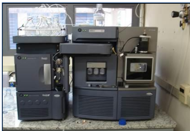
Figura 4. Exemplo de Espectrômetro. Fonte: (Departamento de Química USP, Laboratório de Espectrometria de Massas, 2018).
