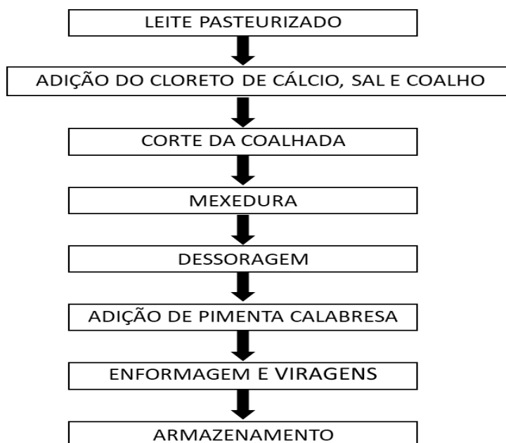
Figura 2. Fluxograma de fabricação do Queijo Tipo Minas Frescal com adição de pimenta calabresa ( Capsicum baccatum ). Fonte: os autores.
