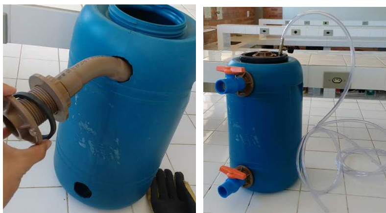
Figuras 2. Biodigestor em montagem e construído, respectivamente. Fonte: arquivo pessoal.
