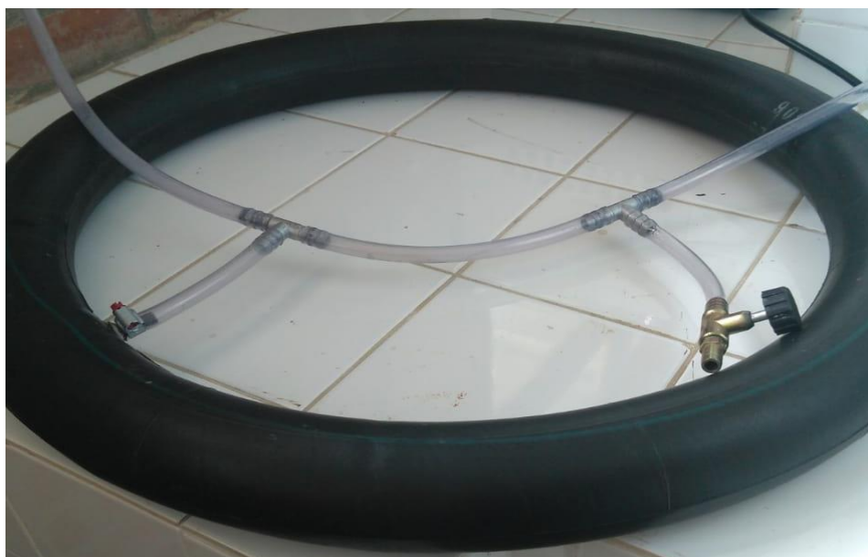
Figura 4. Armazenamento de gases na câmara de ar. Fonte: arquivo pessoal.
