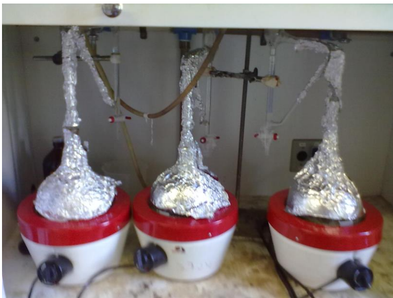
Figura 17. Aparelhos de destilação do tipo Clevenger para destilação com arraste de vapor. Fonte: Os autores.
