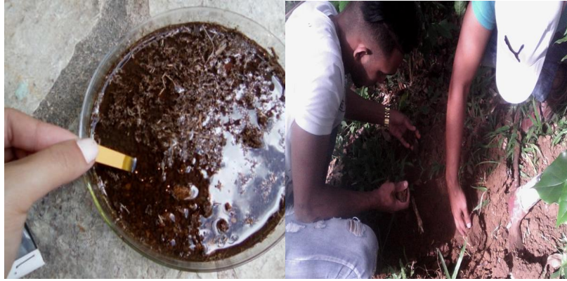
Figura 4. Determinación del pH y color del suelo. Fuente: Los autores.
