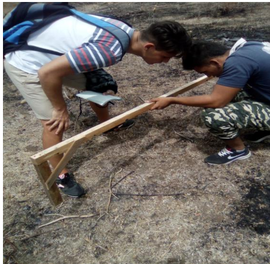
Figura 5. Determinación de la pendiente del área. Fuente: Los autores.
