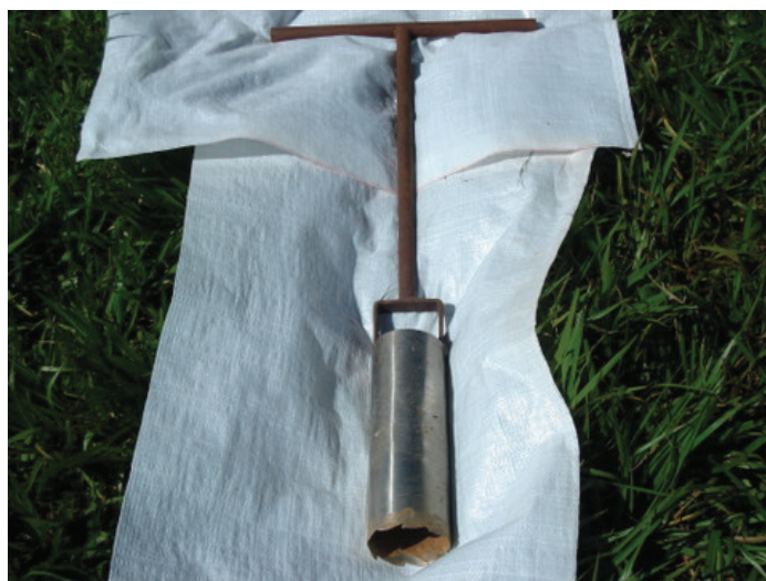
Figura 1. Trado tipo caneca adaptado para amostragem destrutiva de raízes junto com solo. (Foto: Rafael Felipe Ratke).
