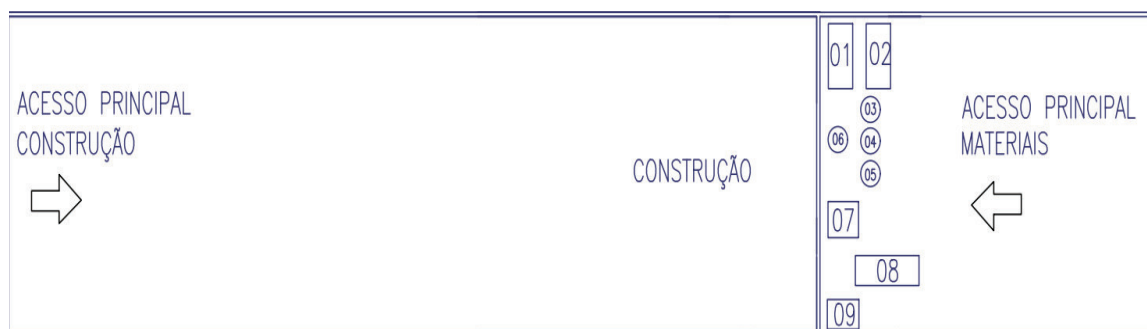
Figura 2. Proposta de arranjo físico de canteiro de obras. 01 – Milheiro de tijolos; 02 – Telhas cerâmicas; 03 – Areia fina; 04 – Areia grossa; 05 – Cascalho; 06 – Betoneira; 07 – Contêiner para armazenamento de documentos, cimentos e equipamentos; 08 – Central de corte e dobra de armaduras; 09 – Caçamba para depósito de entulhos.
